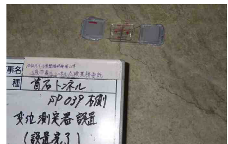
簡易的なひずみゲージ例(首石トンネル)
